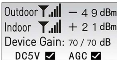
окно с указанием входного сигнала с внешней антенны (outdoor) и усиленного выходного сигнала с внутренней антенны (indoor) а также коэффициент усиления сигнала (device gain).
