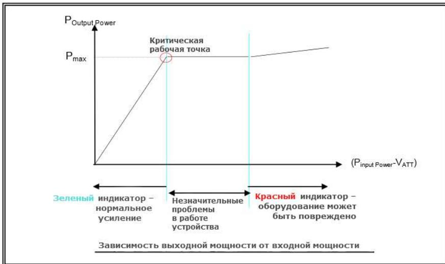
$P_{Output\ Power}$ : Выходная мощность
